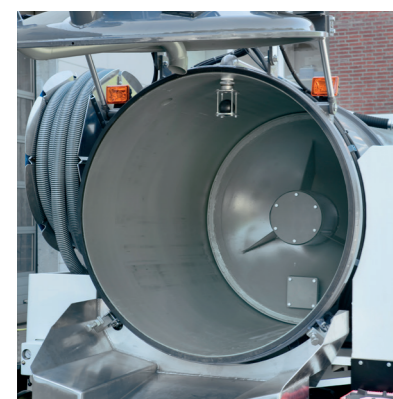
Verplaatsbaar tussenschot optioneel voor FlexCom 10 en 12,5 T
